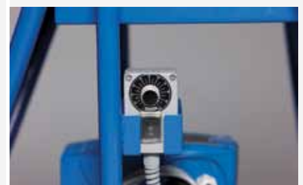
Fernbedienung mit stufenloser Fördermengenregulierung Remote control with continuous delivery control
