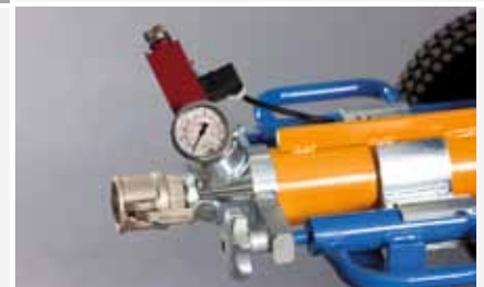
Druckschalter mit Manometer am Maschinenausgang Manometric switch with manometer at machine outlet
