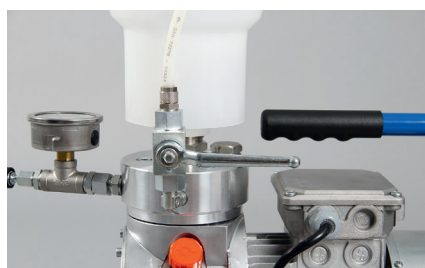
Returslang med kulventil
